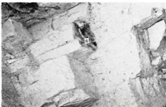
Obr. 6. Monoklinálny priebeh s_2 plôch a výrazný vývoj puklín hornín plášťa v západnej časti prekopu na žilu Agneška (tektonogram 15)
