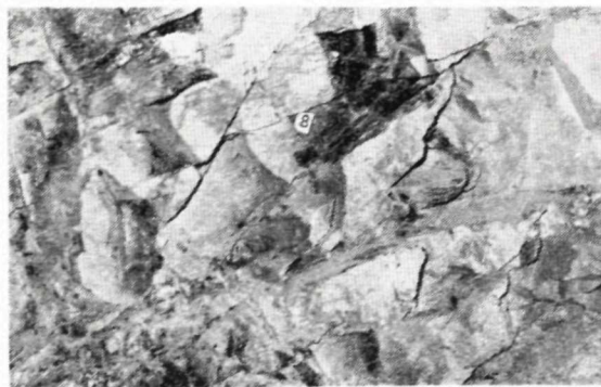
Obr. 8. Vývoj klenbovitej stavby hornín plášťa v prekope na žilu Agneška
